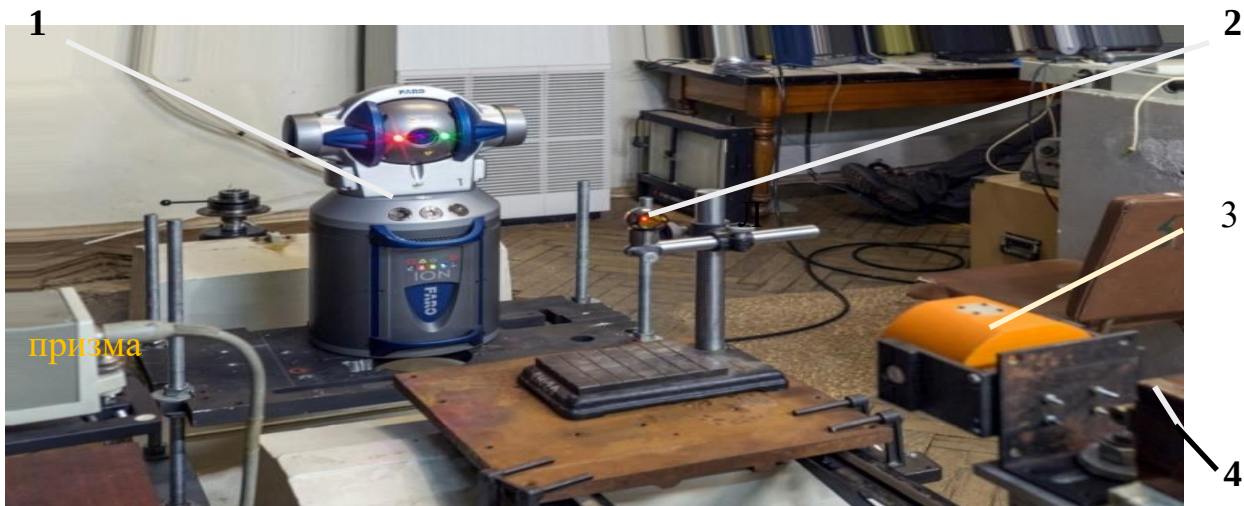
Рисунок 11 - Механическая реализация линейного компаратора с удвоением отсчетов по МКСИ: 1 – исследуемый лазерный трекер, 2 – отражатель лазерного трекера, 3 – поворотный отражатель, 4 - жезл
