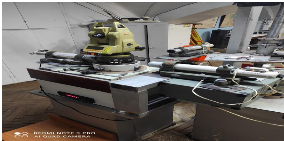
Рисунок 13 – Механическая реализация горизонтального углового компаратора: 1 – исследуемое МКСИ, 1 – автоколлиматор, ориентированный на первую грань призмы, 2 – автоколлиматор, установленный под 90°, автоколлиматор, установленный через 180°, 4 – цифровой блок преобразователя ROD-800, 5 – поворотный стол ватер ROD-800 фирмы «Хайден Хайн (германия).
