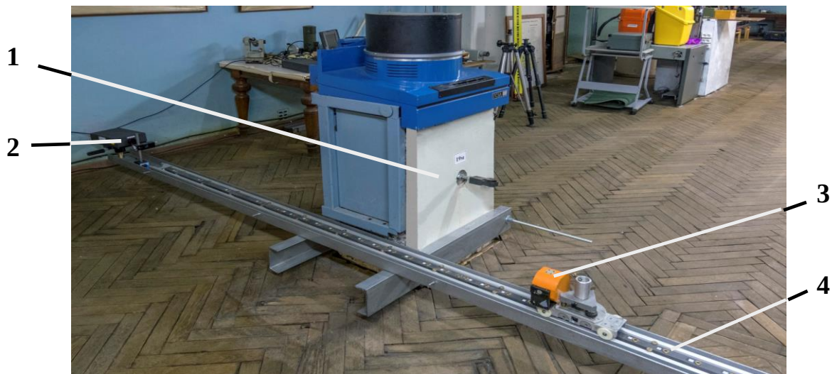
Рисунок 15 – Механическая реализация компаратора с композитным жезлом и лазерным интерферометром: 1 – фундамент, 2 – лазерный интерферометр, 3 – отражатель интерферометра, 4 – направляющая с композитным жезлом
