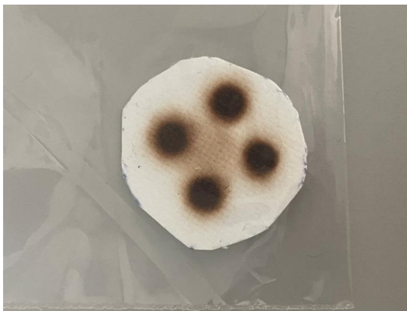
Рисунок 7 – Мембраны с пятнами частиц черного углерода с четко выраженными границами
