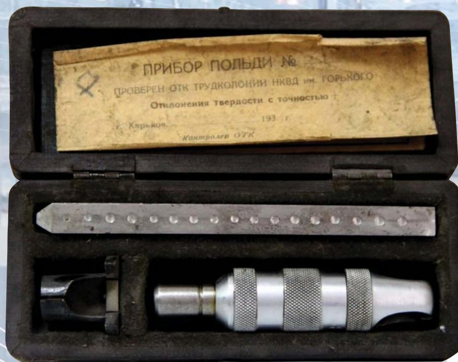
Прибор Польди Твердомер переносной
