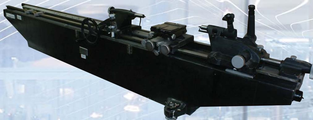
*Машина измерительная оптико-механическая ИЗМ-II
