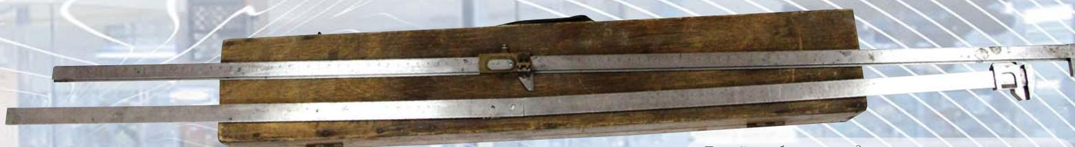
Линейка образцовая для проверки мер штриховых
