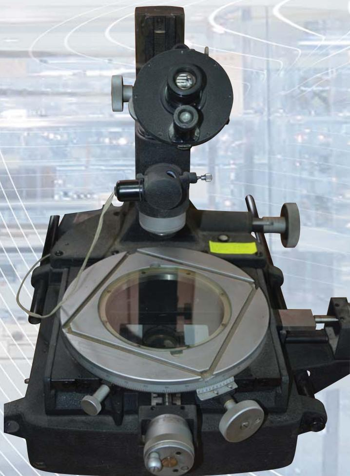
Микроскоп инструментальный, 1961 г.
