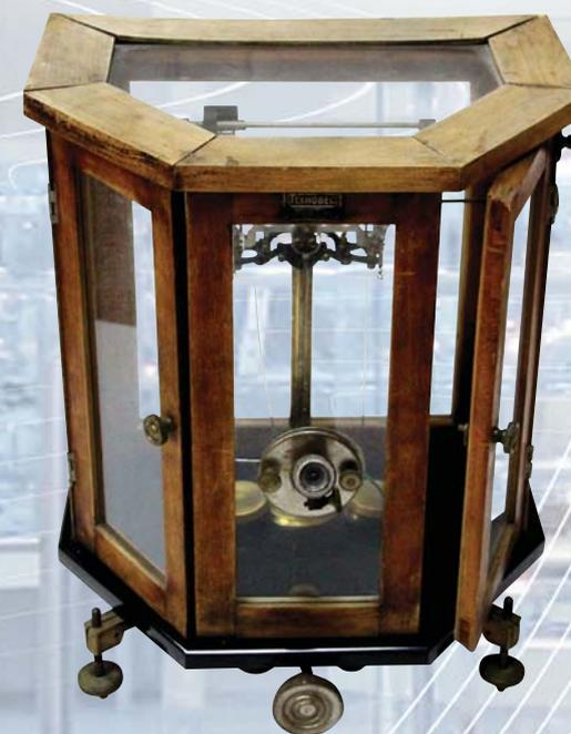
Весы с оптической системой отсчета
