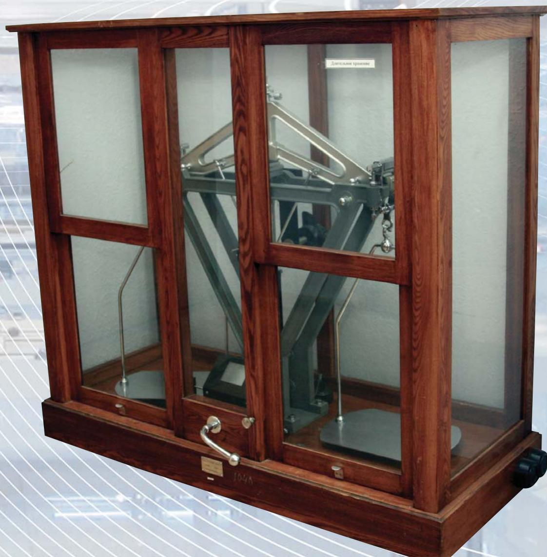
Весы образцовые 2 разряда, предельная нагрузка 20 кг
