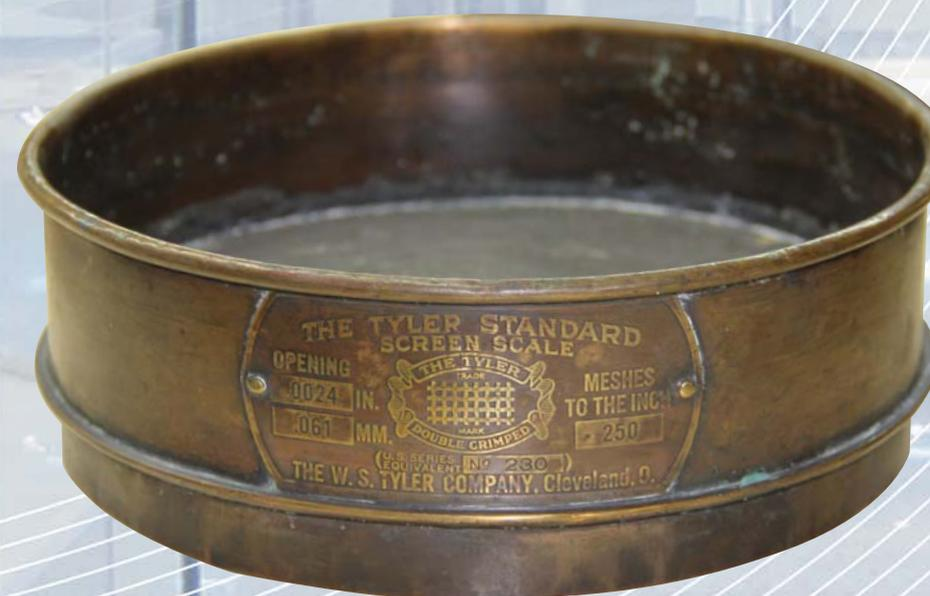
*Сито лабораторное, размер ячеек 0,061 мм
