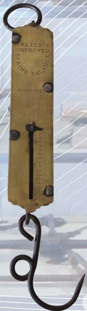
Весы пружинные до 30 фунтов
