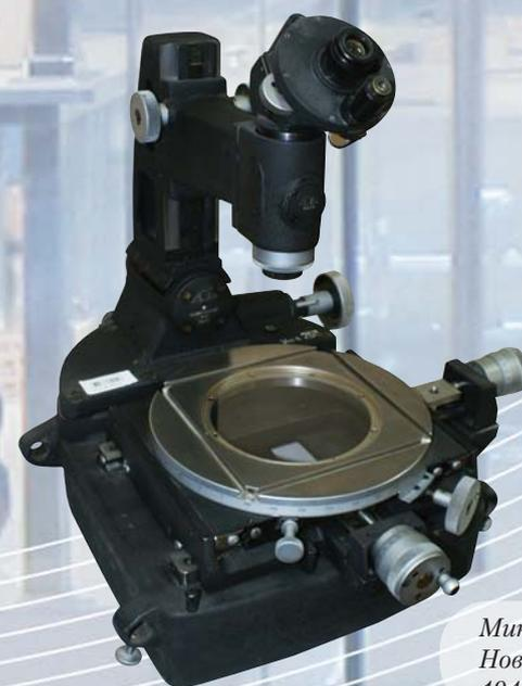
*Микроскоп инструментальный БМИ
