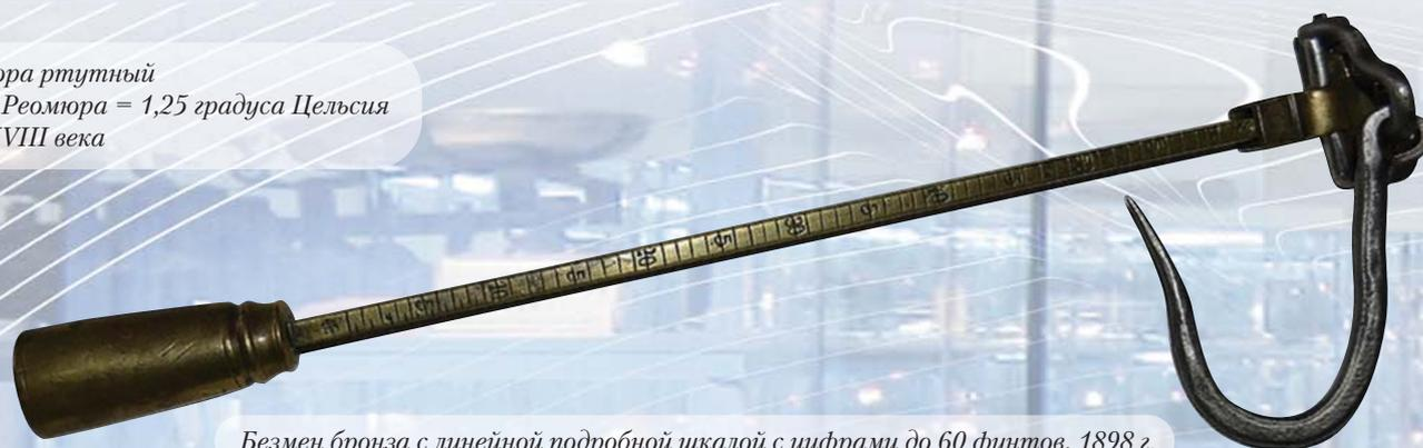
*Безмен бронза с линейной подробной шкалой с цифрами до 60 фунтов, 1898 г.*
