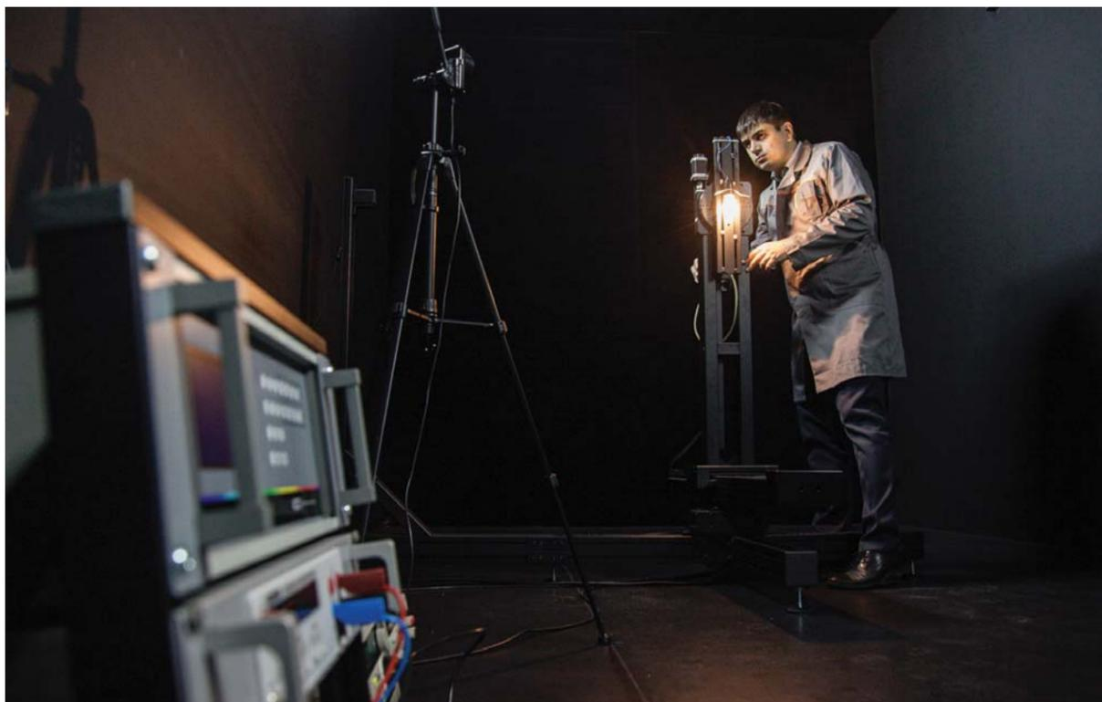
Настройка гониофотометра для измерения функциональных характеристик источников света
