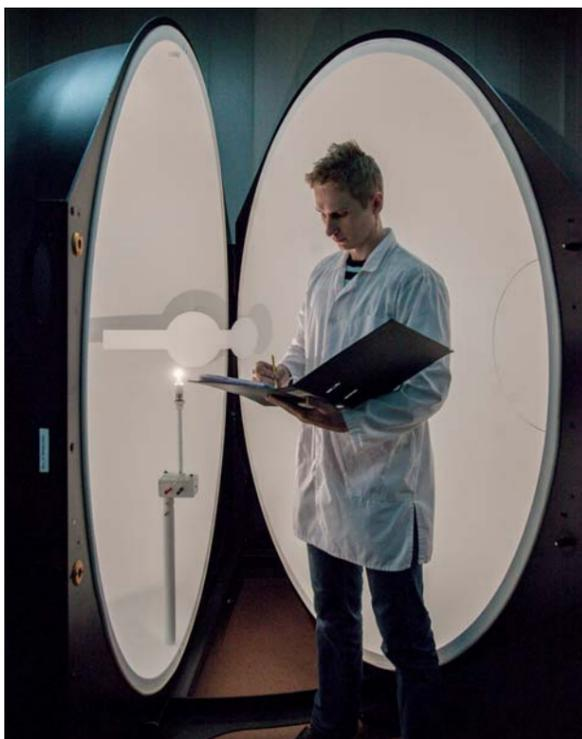
Измерение светового потока источника света в фотометрическом шаре
