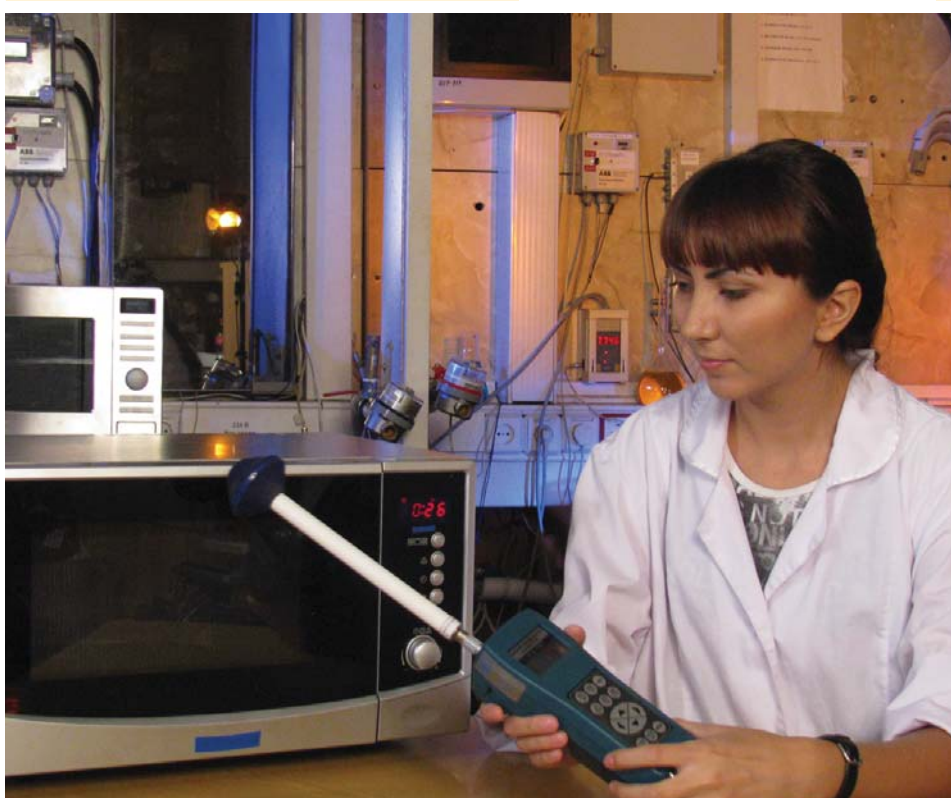
Испытательный центр Ростест-Москва Испытания микроволновой печи на утечку электромагнитного излучения
