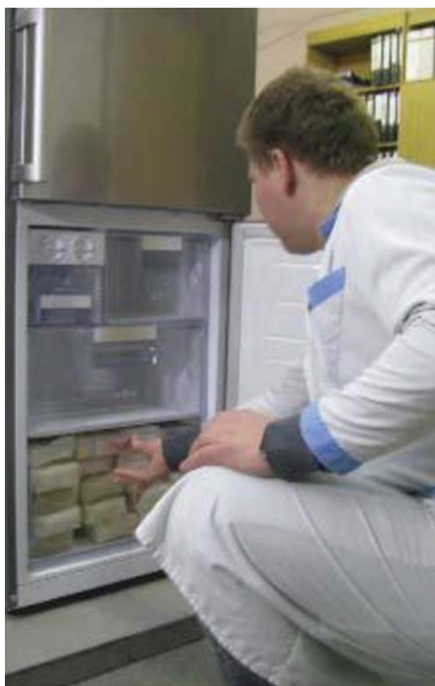
Загрузка М-пакетов (имитирующих постное мясо) в морозильные камеры холодильника LG с линейным компрессором для проверки на энергоэффективность
