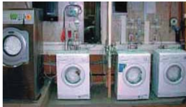
Испытательный стенд для оценки энергоэффективности стиральных машин и их функциональных параметров
